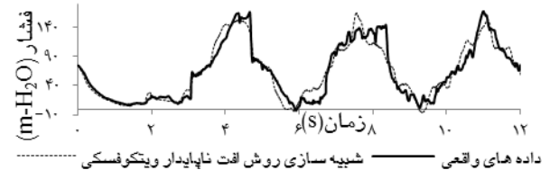
شکل ۱۰- تغییرات فشار در محدوده زمانی ۰ تا ۱۲ ثانیه برای روش افت ناپایدار ویتکوفسکی.
