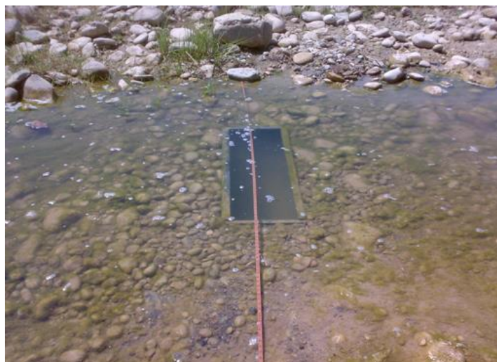
شکل ۲- نمونه بردار چاله‌ای جایگذاری شده در بستر رودخانه.
