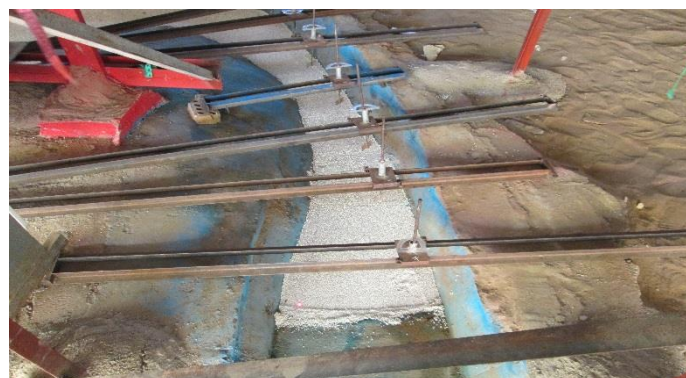
شکل ۳- نمایی از کارگذاری صفحات شناور در قوس قبل از انجام آزمایش.
