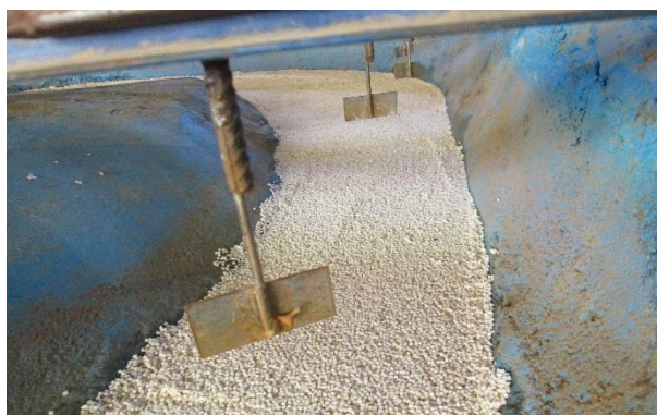
شکل ۴- نمائی نزدیک از نصب صفحات.
