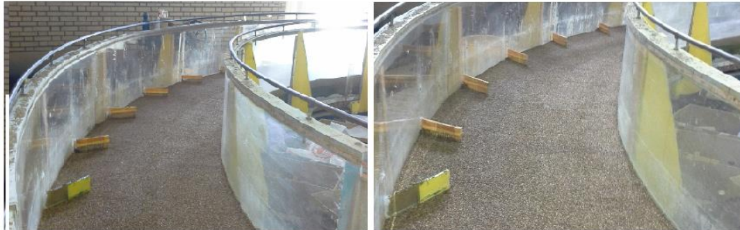
شکل ۲- جانمایی سازه‌ها در فلوم، الف: ۶۰ درجه (جاذب) ب: ۱۲۰ درجه (دافع).
