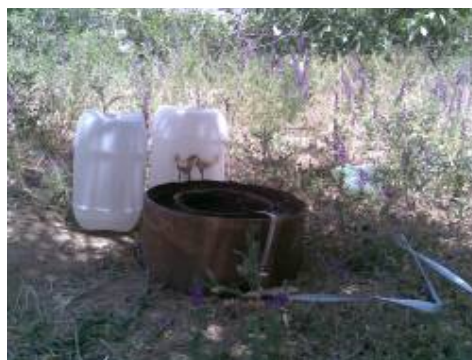
شکل ۳- تصاویری از نحوه اندازه‌گیری نفوذ به روش استوانه مضاعف.
