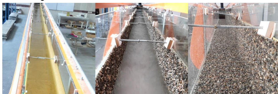
شکل ۳ - نمونه کانال‌های زبر تهیه شده با استفاده از قطعات پیش ساخته.
