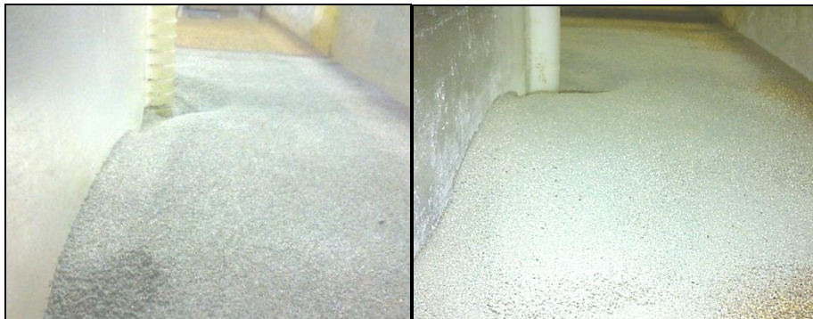
شکل ۱۰- مقایسه تصاویر پدیده آبشستگی در تکیه‌گاه شاهد و تکیه‌گاه زبری‌دار a=0.45L .
