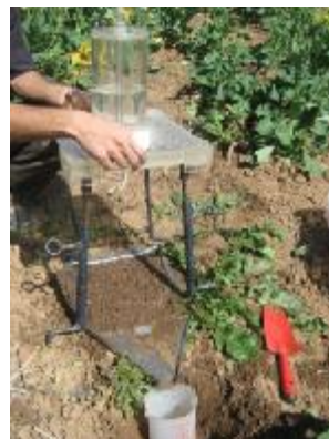
شکل 2- شبکه نمونه برداری و چگونگی همانندسازی باران در مزرعه مورد بررسی.
