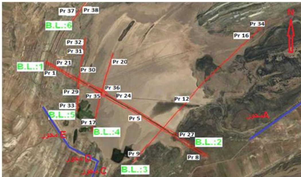
شکل ۵- موقعیت پروفیل‌های لرزه‌نگاری انجام شده در داخل مخزن سد آرباتان
