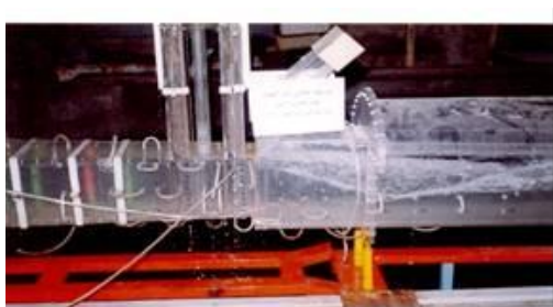
شکل 4- مدل دریچه سرویس گتوند علیا در حین آزمایش، ارتفاع معادل فشار آب مخزن 4 متر، بازشدگی دریچه 100٪.
