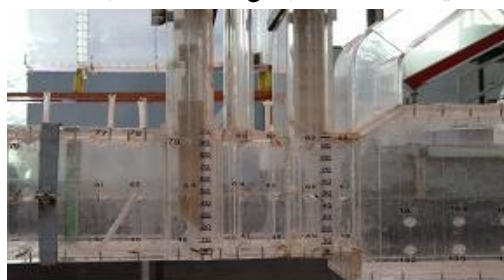
شکل 3- مدل تخلیه کننده تحتانی سد گتوند علیا در محل شکاف دریچه.
