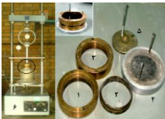
شکل 1- قالب تراکم مورد استفاده جهت ساخت نمونه‌ها
