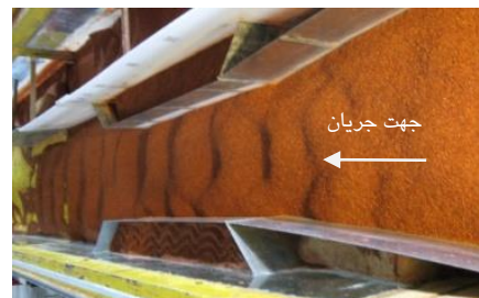
شکل ۴- نمایی از فرم بستر ریپل تشکیل شده با وجود تبدیل با زاویه ۵ درجه
