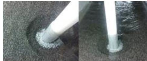
شکل ۱۰- نمایی از وضعیت حفره آبشستگی محافظت شده با مواد نانورس.
