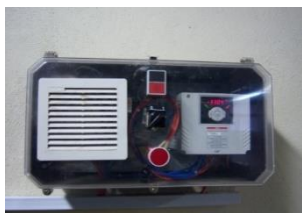
شکل ۲- دستگاه تنظیم فرکانس دبی جریان.
