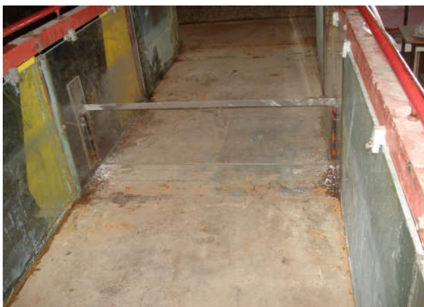
شکل ۲ - تصویری از سازه جریان ترکیبی نصب شده در فلوم آزمایشگاهی.
