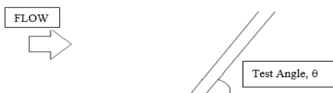
شکل ۹- نحوه قرارگیری لوله‌ها با زاویه برخورد کوچکتر از 90^\circ درجه در کانال.
