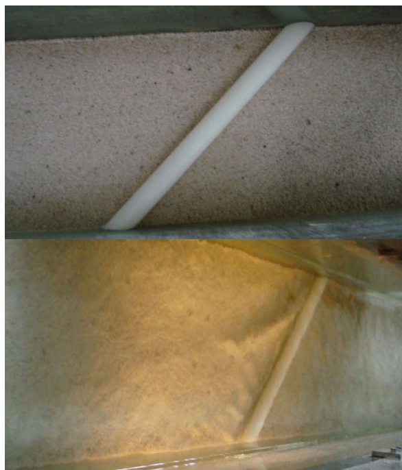
شکل ۱۰- تصاویر پروفیل آبشستگی برای زاویه برخورد کمتر از ۹۰ درجه.
