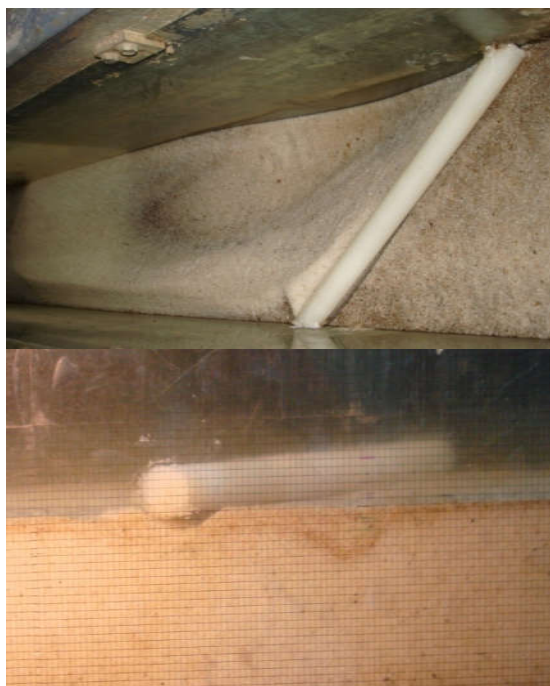
شکل ۱۰- تصاویر پروفیل آبشستگی برای زاویه برخورد کمتر از ۹۰ درجه.
