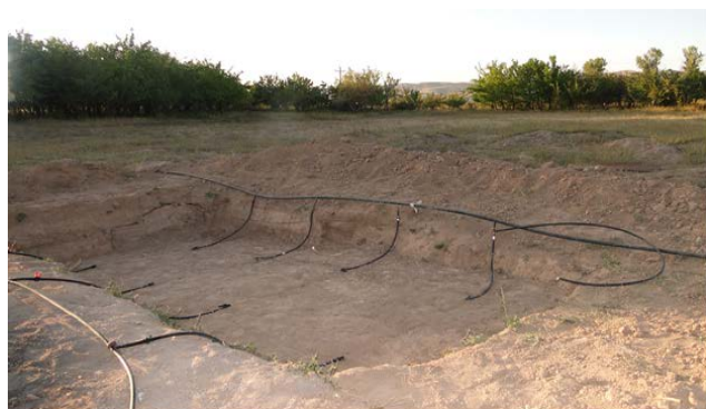
شکل ۲- شبکه لوله‌های اصلی، فرعی و قطره‌چکان‌های قطعه آزمایشی.
