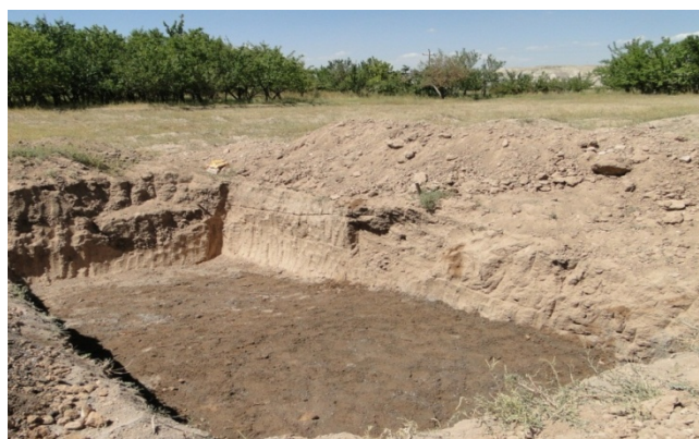
شکل ۱- کف قطعه آزمایشی (نصف قطعه مسطح و نصف دیگر شیب‌دار).
