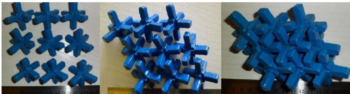
شکل ۶- تراکم‌های مختلف کارگذاری قطعات شش‌پایه.
