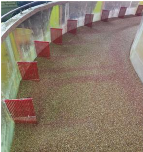
شکل 3- نمایی از فلوم قوسی به همراه آبشکن‌های نصب شده.
