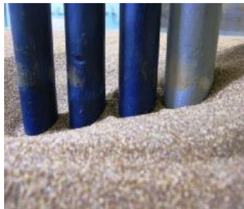
شکل 7- حفره آب‌شستگی در حضور شمع 32 میلی‌متری.
