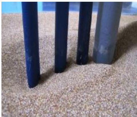
شکل 8- حفره آب‌شستگی در حضور شمع 20 میلی‌متری.
