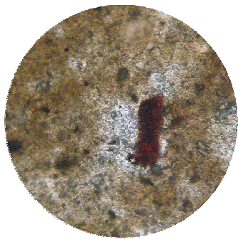
شکل 2- ندول آهن 200x- PPL- P1- Ayz
