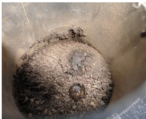
شکل ۲- آزمایش آب‌گریزی روی نمونه‌های خاک.
