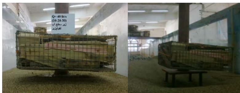
شکل ۷- نمایی از آبشستگی (در حالت زیر سطح آب) و تپه‌های ماسه‌ای در زمان ۴۲۰ دقیقه.
