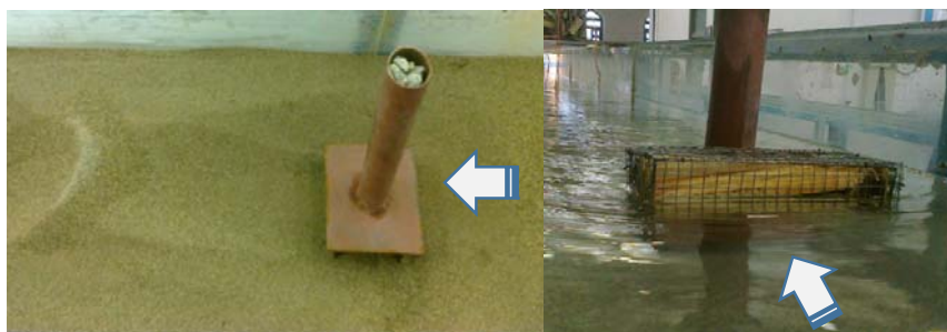
شکل ۸- نمایی از آبشستگی (در حالت بالای سطح آب) و تپه‌های ماسه‌ای در زمان ۴۲۰ دقیقه.
