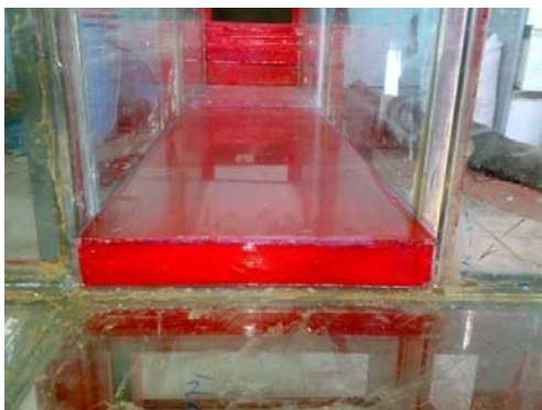
شکل ۱- اختلاف تراز بین کانال اصلی و فرعی خروجی.
