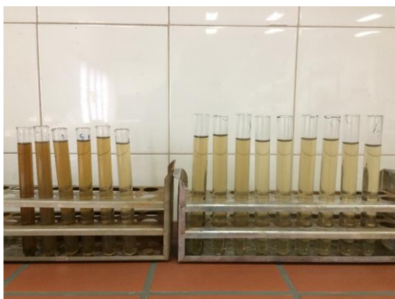
روند خالص سازی هیومین از هیومیک و فولویک - شکل ۱ اسید.
