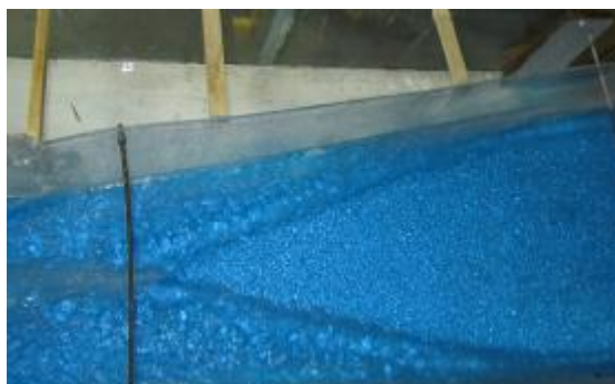
شکل 2- تشکیل امواج ضربه‌ای در تبدیل همگرا با دیواره مستقیم به‌ازای Fr_1=7
