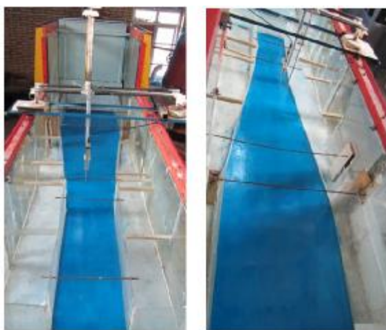
شکل 1- تبدیل همگرا با دیواره‌های مستقیم (الف): نما از بالادست (ب): نما از پائین دست.
