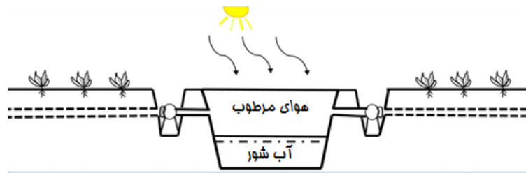
شکل ۱- نمای کلی سیستم آبیاری چگالشی (لیندبلوم ۲۰۱۲).
