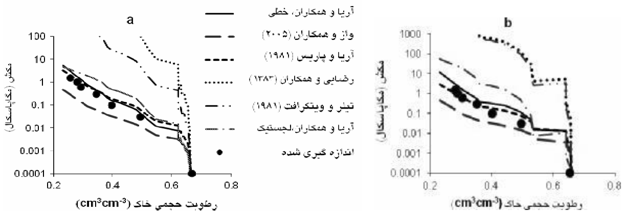
شکل 2- منحنی مشخصه آب خاک. a: بافت رس سیلتی (خاک شماره 2)، b: بافت لوم رسی سیلتی (خاک شماره 4)
