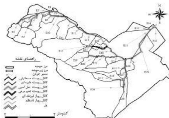
شکل 5- نقشه تلفیقی زیرحوضه‌ها و سیستم انتقال رواناب سطحی حوضه اقبال شرقی در GIS.
