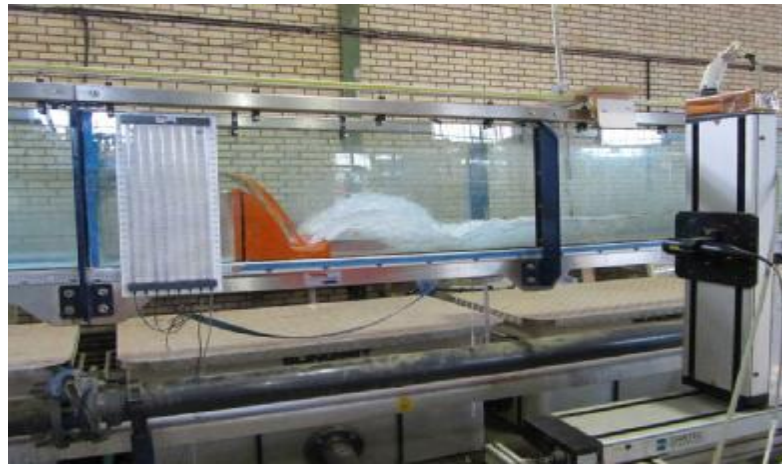
شکل 1- سرریز و تجهیزات اندازه‌گیری.
