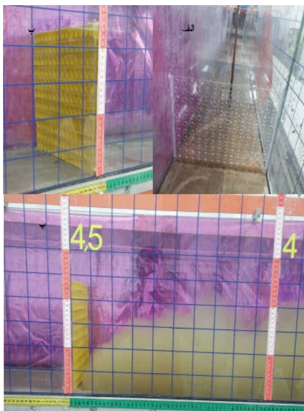
شکل ۸- الف) صفحه متخلخل، ب) مانع متخلخل و پ) برخورد جریان.
