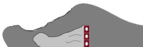
شکل ۴- نوع اول: جریان عبوری از روی چینه جلوتر از جریان عبوری از داخل چینه.
