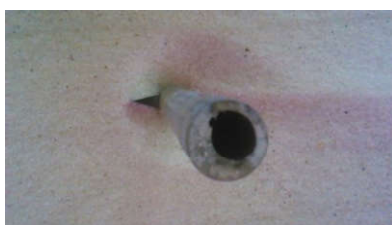
شکل ۹- توپوگرافی ایجاد شده در بستر رسوبی در پایان آزمایش I.
