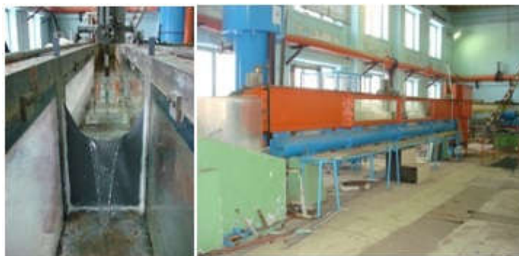
شکل ۲- نمایی از فلوم آزمایشگاهی به‌همراه سرریز نصب‌شده در داخل آن.
