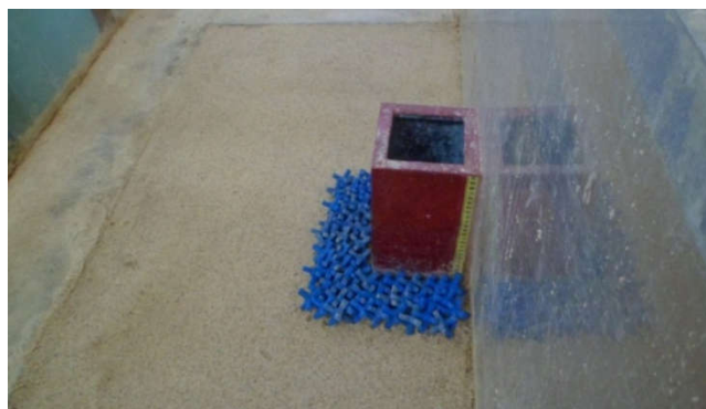
شکل ۸- کارگذاری قطعات شش‌پایه در اطراف تکیه‌گاه پل در فلوم آزمایشگاهی در حالت متراکم بر روی بستر.
