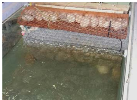
شکل ۴- سیستم شبکه لوله های آرام کننده جریان.
