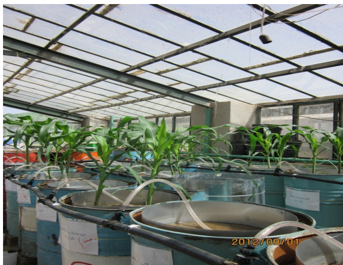
شکل ۲- مجموعه لایسی‌مترها و سیستم آبیاری مورد استفاده.
