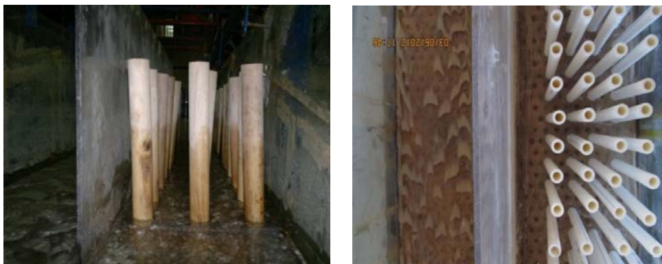
شکل ۶- تصاویری از نحوه ی آرایش موانع در طول یک طرف دیوار جداکننده عرض کانال.
