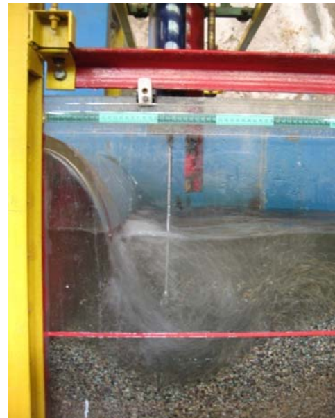
شکل ۲- اندازه گیری مولفه های سرعت با دستگاه سرعت سنج الکترومغناطیس JFE ALEC مدل ACM3-RS.
