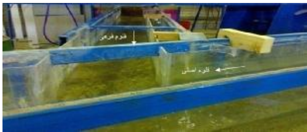
شکل 2-کانال اصلی و نحوه اتصال آن به کانال فرعی.
