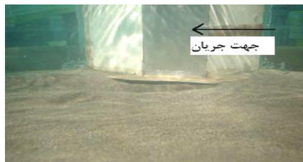
شکل 11- تصویری از شیار ایجاد شده در اطراف آبشکن
