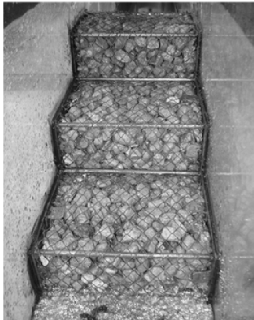
شکل 2- مدل فیزیکی سرریز پله‌ای گابیونی با شیب 1:2 نصب شده داخل کانال.
