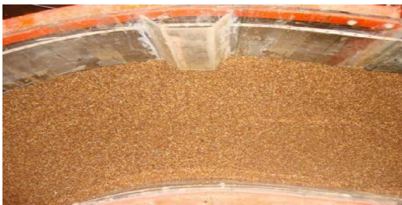
شکل 2- نمایی از تکیه‌گاه پل به کار رفته در آزمایشات
